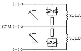
注) OFF時のコイルサージ電圧は約-60V発生します。コイルサージ電圧をさらに抑える必要がある場合は別途当社にご確認ください。
