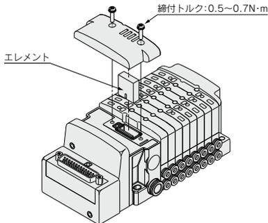
交換はENDプレート上側のカバーを外し、マイナスドライバ等で旧ELEMENTを取出してください。
