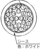
標準電気配線仕様として12連までは、内部配線はバルブおよびオプションのタイプに関わらず、各連数共ダブル配線(SOL.A, SOL.Bへ結線)になっています。オプションとしてシングル配線、ダブル配線の混合配線が可能です。詳細は下記、配線仕様特殊(オプション)をご覧ください。
