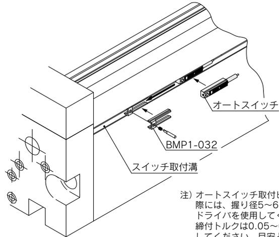
注) オートスイッチ取付ビスを締付ける際には、握り径5~6mm程度の時計ドライバーを使用してください。また締付トルクは0.05~0.1N・m程度としてください。目安として締付感が出た位置から90°回転させた程度となります。
