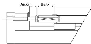
図3. ストローク最大調整時詳細
