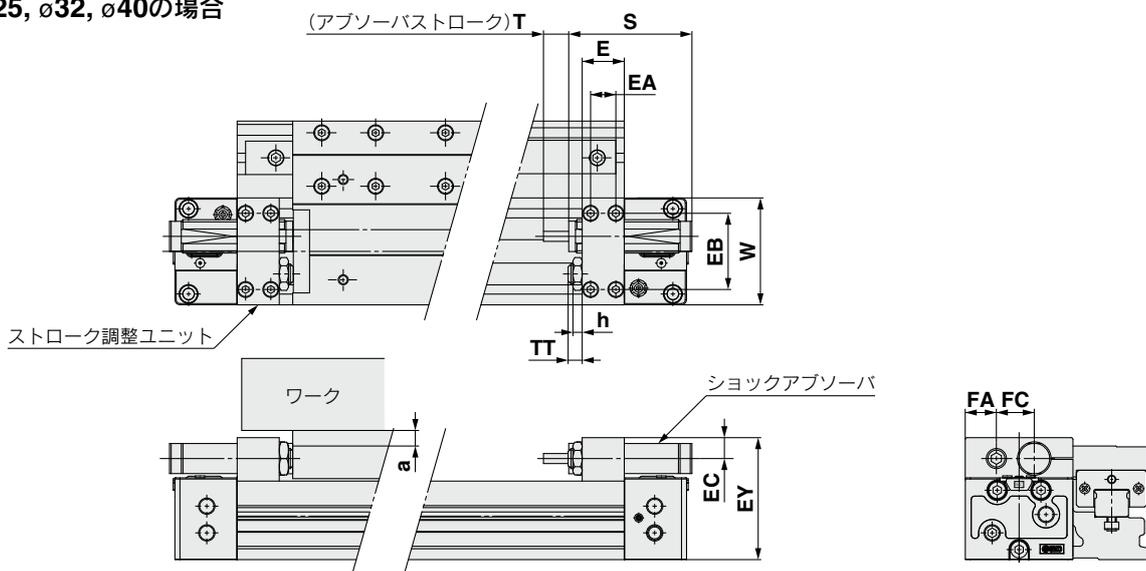
※HタイプのユニットのEY寸法はスライドテーブル面高さ(H寸法)より高くなりますので、スライドテーブル全長(L寸法)を超えるワークを取付ける場合はa寸法以上の段差またはスペーサをワーク側で確保してください。
