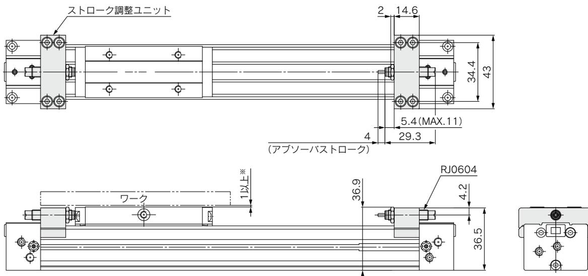
※ストローク調整ユニット高さ寸法(36.9mm)はスライドテーブル面高さ(37mm)とクリアランスが小さく、干渉する可能性がありますのでスライドテーブル全長を超えるワークを取付ける場合は1mm以上の逃げをワーク側で確保してください。
