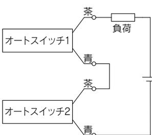
オートスイッチ2個をAND接続した場合ON時の負荷電圧が低下し負荷の作動不良を生じる場合があります。また、表示灯はオートスイッチ2個がON状態となったとき点灯します。負荷電圧仕様が20V未満のオートスイッチは、使用できません。
