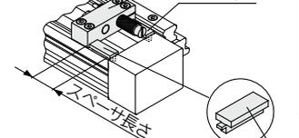
突起部を調整ユニット側に設置します。
