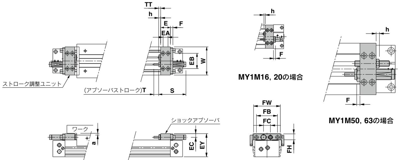
※HタイプのユニットのEY寸法はスライドテーブル面高さ(H寸法)より高くなりますので、スライドテーブル全長(L寸法)を超えるワークを取付ける場合はa寸法以上の逃げをワーク側で確保してください。
