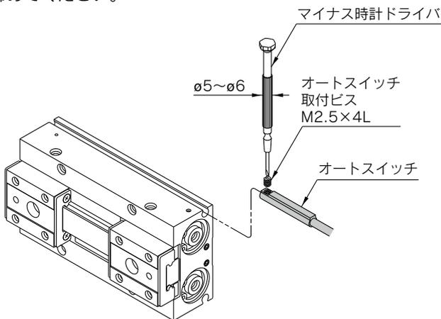
注) オートスイッチ取付ビスを締付ける際には、握り径5~6mm程度の時計ドライバを使用してください。
