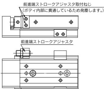
前進端ストロークアジャスタなしの場合は六角穴付止めねじでプラグをして工場出荷をしています。
